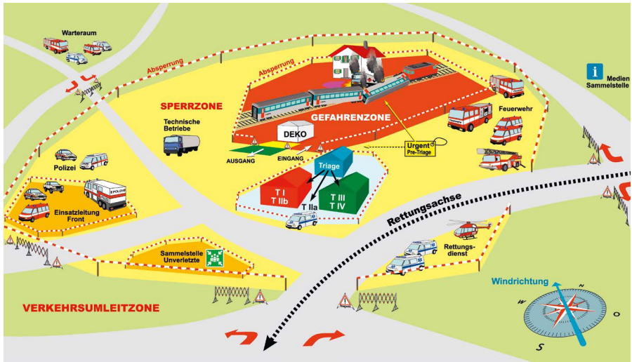
Abb 12: Darstellung einer Schadenplatzorganisation (Handbuch Führung Grossereignisse, © FKS)
