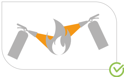
Abb. 31: Mehrere Feuerlöscher gleichzeitig einsetzen, nicht nacheinander!
