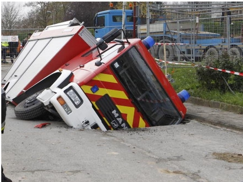
Abb. 19: Fahrzeugeinsturz wegen unterspülter Strasse (Luxemburger Wort).
