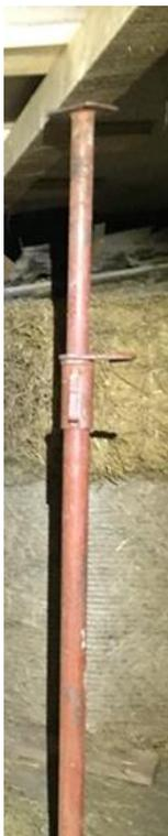
Abb. 46: Einzelstützen aus dem Bausektor (Blockhaus, THW)
