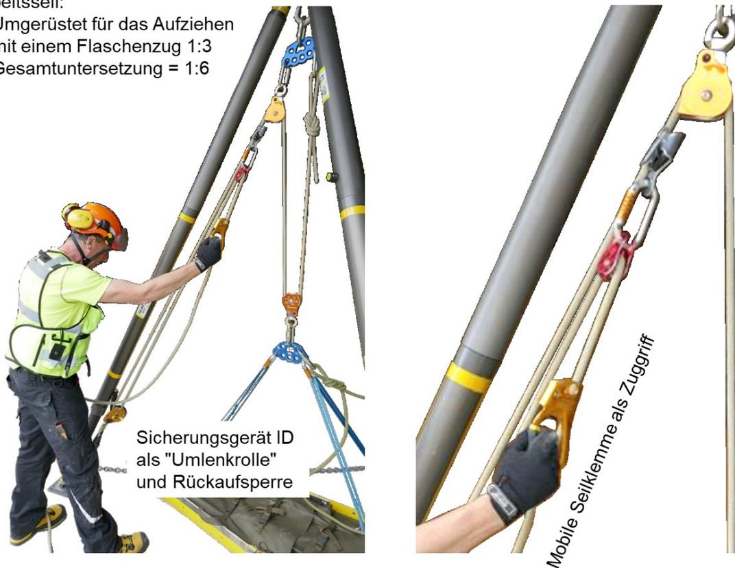
Abb. 72: Aufziehen einer Bahre mit einem Schwerlastdreibein und einem Universal-Flaschenzug
