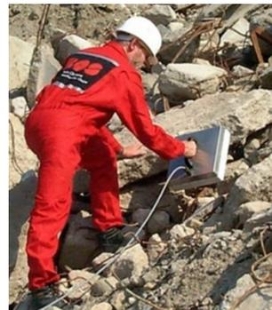
*Abb. 42: Beispiel Bio-Radargerät (MEDER)*
