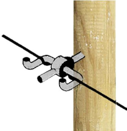
Abb. 23: Stützpunkt mit Kabelträger aus Metall
