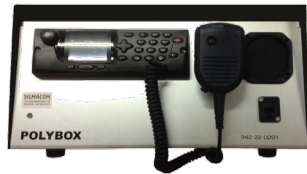
Abb. 14: Fixstation Polybox mit TPM700 Gerät Beispiel vom Kanton Wallis.
